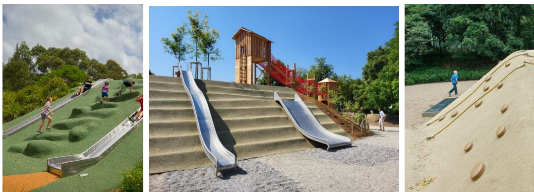
Igralo 14 / HRIB IZ OBLIKOVANE EPDM GUME. Na zunanji strani hribčka razgibana brežina iz EPDM gume, namenjena plezanju in dostopu do vrha tobogana ter vrha brežine. Površina je oblikovana tako, da spodbuja motorične spretnosti otrok, z valovito strukturo in različno strmimi nakloni, ki ponujajo različne stopnje izziva. Na brežini plezalni oprijemi, ki otrokom omogočajo varen in zabaven vzpon. Material (EPDM) zagotavlja mehko, ne drsečo in varno površino, primerno za igro tudi v primeru padca.
